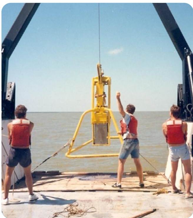
Lançamento de boxcorer em estudo sobre a sedimentação na Plataforma Continental Brasileira
